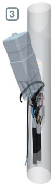
Mise en place du fourreau isolant, sur le bornier et sur tous les câbles.
