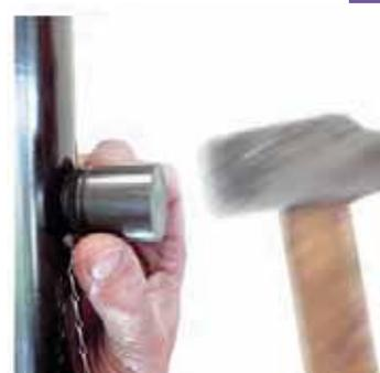
Insertion à force de la base d'alimentation dans le trou grâce à la bouterolle.
