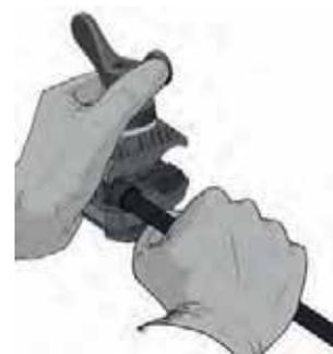
3. Serrer à la main jusqu'à rupture de la tête fusible papillon.
